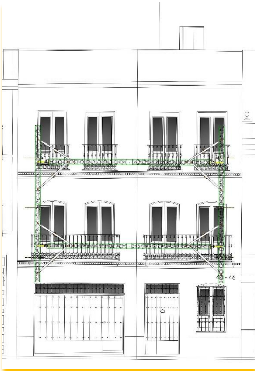
Sistema Soldier MKII, como puntales horizontales de altas cargas para el apuntalamiento de muros medianeros.
