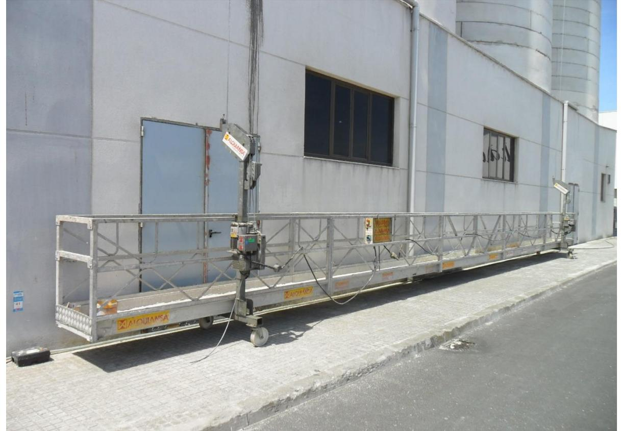
En la Harinera del Puerto Franco de Cádiz se han acometido diversas intervenciones, el mantenimiento de los silos y la colocación de una estructura metálica para las que se han utilizado andamios colgantes motorizados
