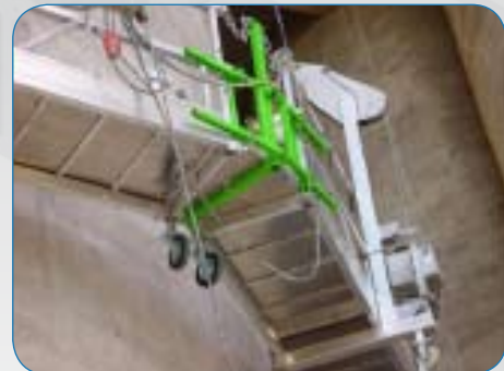
Plataforma con angular regulable y liras en "C"
